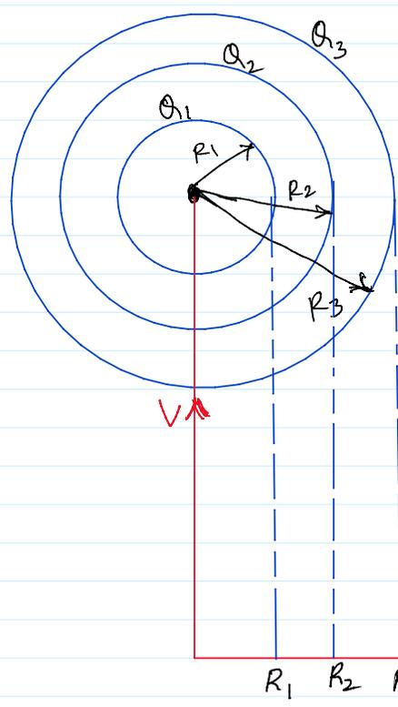
$$V_3 = \frac{kQ_3}{R_3} + \frac{kQ_2}{R_3} + \frac{kQ_1}{R_3}$$
